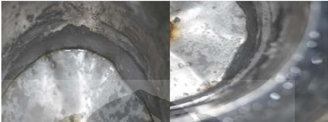
Gambar 4.24. Bongkahan Es dari Hasil *Ice slurry* Salinitas 18 ppt dengan 30 ppt
