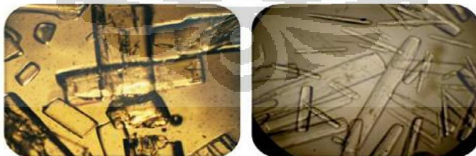
Gambar 2.27. Mirroskopis *Ice slurry* Larutan Asam Acrylic dan Ethyl Lactate
