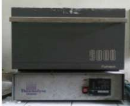
Gambar 3.3. Alat Furnace Thermolyne 6000 digunakan untuk sintering sampel
