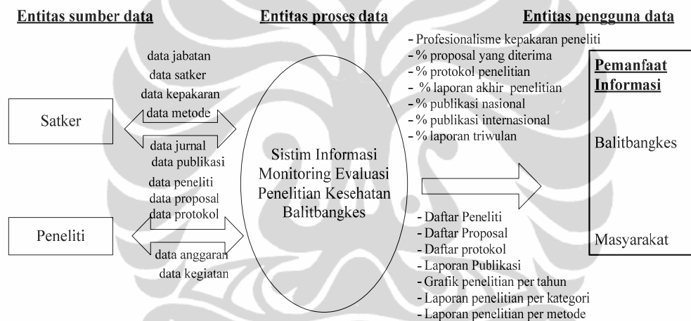
Gambar 5.2. Diagram Konteks Sistem Informasi Monitoring Evaluasi Penelitian Kesehatan di Badan Litbangkes
