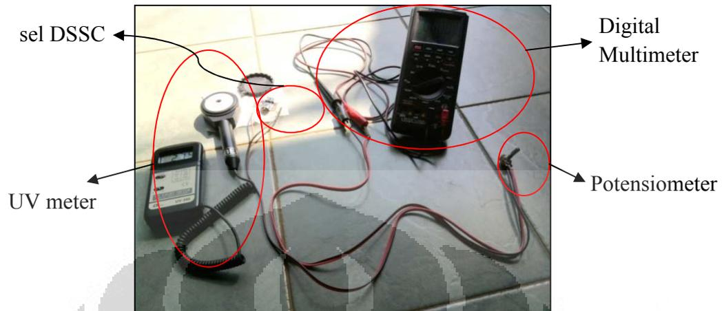
Gambar rangkaian alat pengukuran kinerja sel DSSC dengan potensiometer dan digital multimeter
