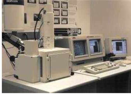
**Gambar 2.10** Alat SEM, terdiri dari kolom elektron, tempat sampel, detektor EDS, *electronic console* dan monitor
