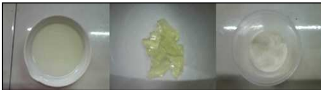
Gambar 4.2 a. Sol \text{TiO}_2 , b. Gel \text{TiO}_2 , c. Padatan \text{TiO}_2 setelah kalsinasi
