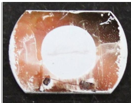
Gambar 4.3. Lapisan film tipis Zn excimer pada temperature substrat 30°C
