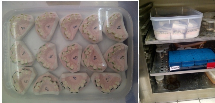
Gambar 16. Semua prototipe diletakkan pada wadah akrilik, direndam dengan larutan saliva buatan hingga ke semua permukaan, kemudian disimpan dalam mesin inkubator bersuhu 37 0 C selama waktu yang ditentukan
