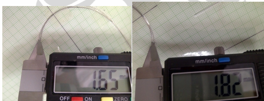
Gambar 20. Jarak defleksi antara kedua kawat tersebut diukur menggunakan kaliper digital (jarak tersebut yang didefinisikan sebagai besar deformasi permanen)
