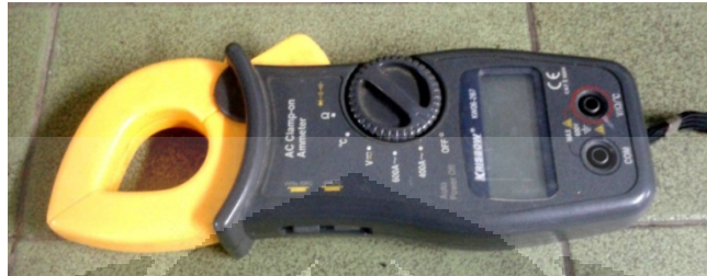
Gambar 3. 8 Clampmeter yang digunakan untuk mengetahui arus kompresor.
