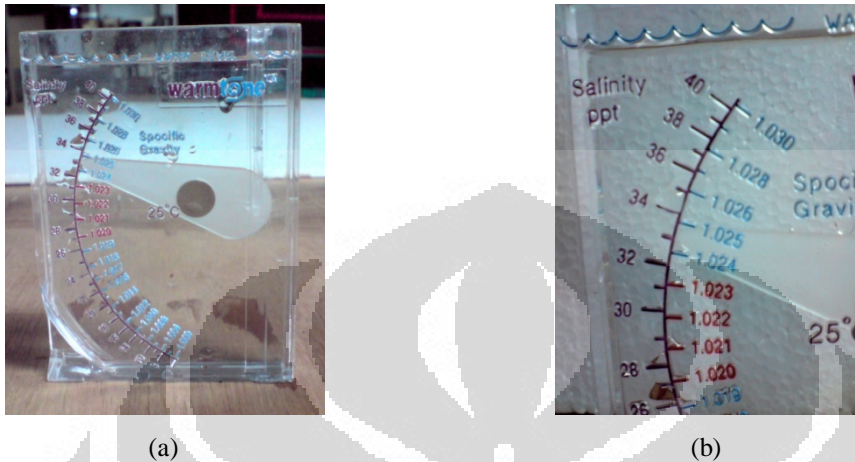
Gambar 3. 10 (a) Salinity hydrometer yang digunakan untuk mengetahui nilai salinitas air laut yang digunakan. (b) Jarum indikator menunjukkan salinitas sebesar 33 ppt dengan nilai specific gravity sebesar 1,0245.
