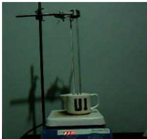
Gambar 3.3 Pengaturan alat pengujian fenomena SCO senyawa kompleks pada keramik model SCO
