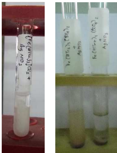
Gambar 4.7 Pengujian penggantian anion: (a). \text{Fe}(\text{Htrz})_3\text{Cl}_2 dengan \text{AgNO}_3 terbentuk endapan putih; (b). [\text{Fe}(\text{Htrz})_3](\text{ClO}_4)_2 dan [\text{Fe}(\text{Htrz})_3](\text{BF}_4)_2 dengan \text{AgNO}_3 tidak terbentuk endapan putih
