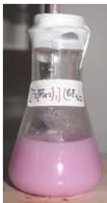
Gambar 4.4 Endapan senyawa kompleks [\text{Fe}(\text{Htrz})_3](\text{BF}_4)_2
