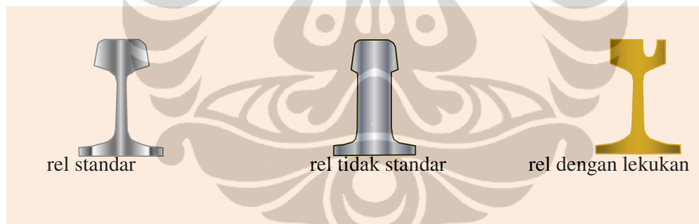
Gambar 2.4 Profil Rel untuk Jalan KA (Esveld, 2001)
