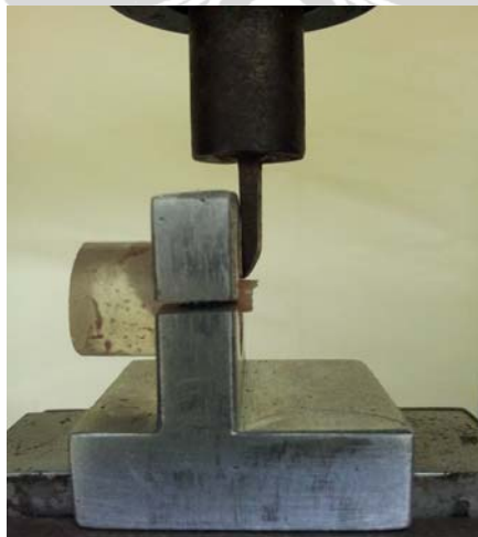
Gambar 4.6: Cara Uji Kuat Rekat Geser dengan Menggunakan Universal Testing Machine (Shimadzu, Japan)
