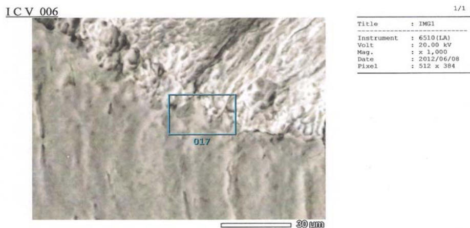
Gambar 5.6.a Daerah Analisa dengan EDS pada Lapisan Hibrid (yang diberi tanda kotak)
