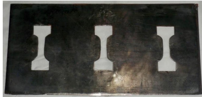
Gambar 3.5. Cetakan mikro tensile untuk pengujian tarik polimer (PVC)
