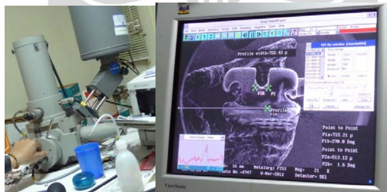
Gambar 2. Pengambilan gambar dengan alat SEM, sudut pengambilan gambar diatur terlebih dahulu. Filter software SemAfore digunakan untuk memperoleh gambar yang lebih baik.
