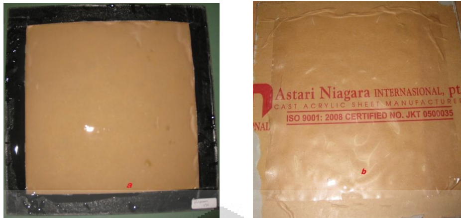
Gambar 4.8. Bioplastik dengan 1% Kitosan, 25% gliserol a) Setelah dicetak b) setelah proses pengeringan.
