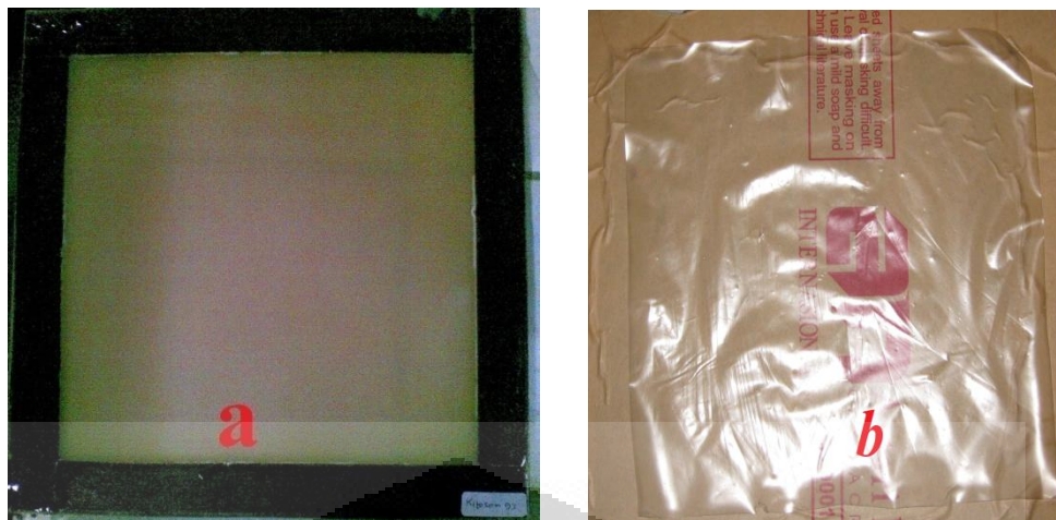
Gambar 4. 11. Bioplastik dengan 9% Kitosan, 25% gliserol Setelah dicetak b) setelah proses pengeringan.
