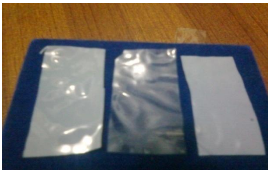
Gambar 4. 28. Bioplastik berukuran 2,5x1,5 cm sebagai sampel soil burial test
