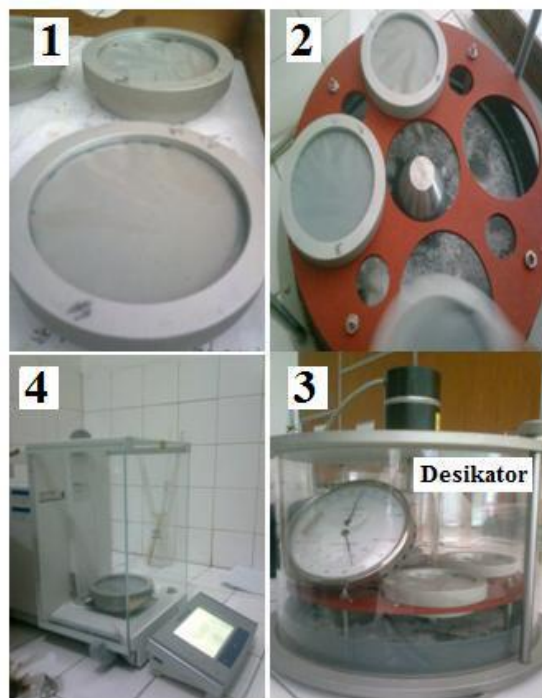
Gambar 4. 27. Ilustrasi prosedur pengujian WVTR yang mengacu pada ASTM E-96 M-05
