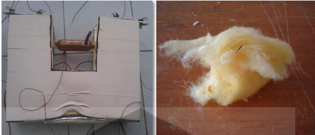
Gambar 3.10 Isolasi Pipa Kalor Melingkar dengan Polyurethane dan Glasswool
