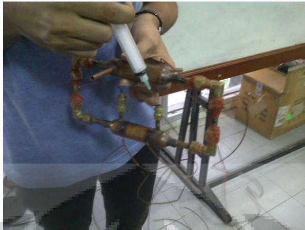
Gambar 3.12 Proses Penyuntikan Fluida Kerja Ke dalam Pipa Kalor Melingkar
