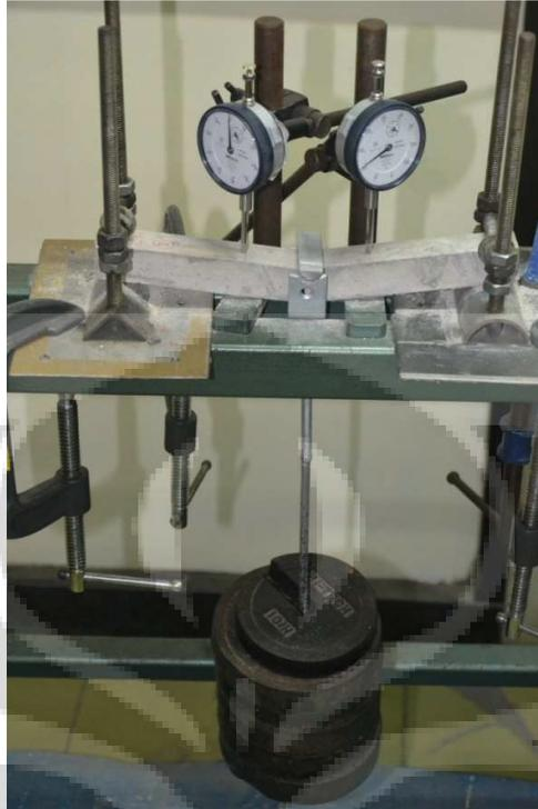
*Gambar 3.4 Pengujian modulus elastisitas mortar.*
