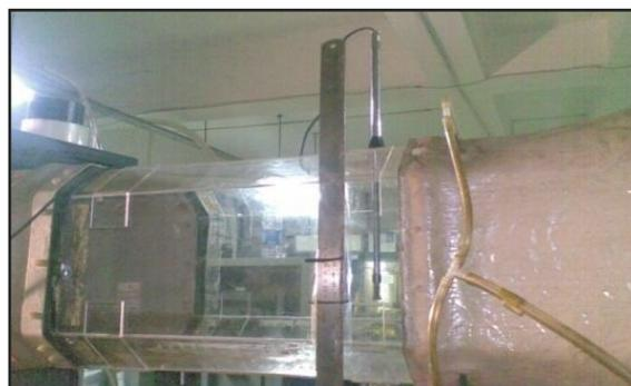
Gambar 3.16 Pengukuran kecepatan aliran dalam seksi uji
