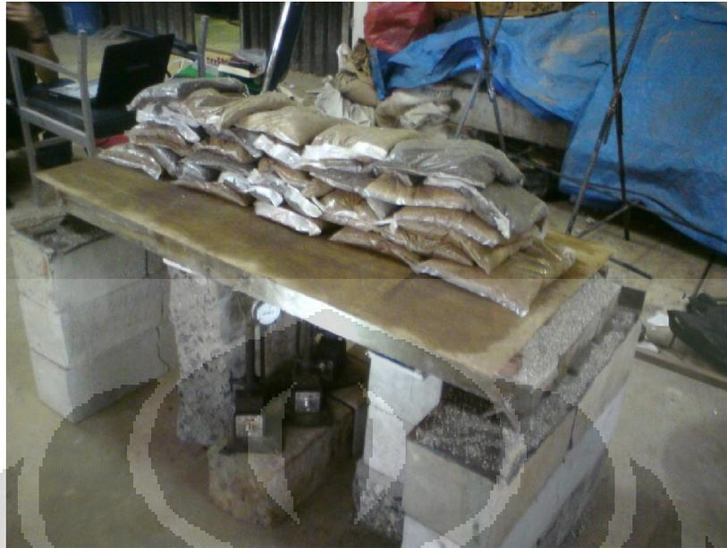
Gambar 3.24 Proses pembebanan
