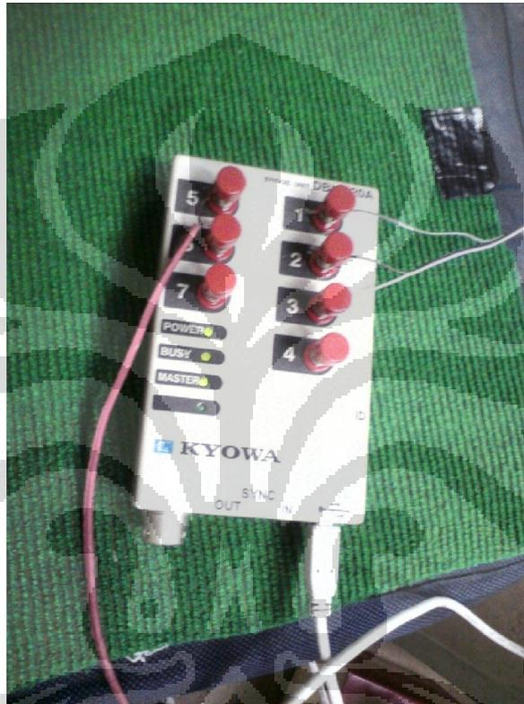
Gambar 3.26 Kabel *Strain Gage* pada Kyowa DBU-120A
