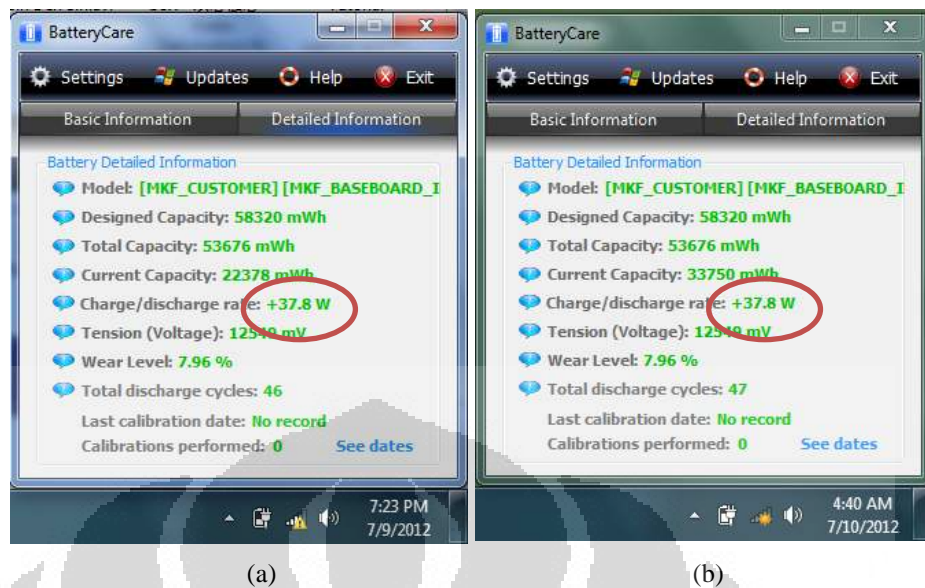
Gambar 4.8 Perbandingan charging rate pada (a) sistem regulator dan (b) adaptor asli
