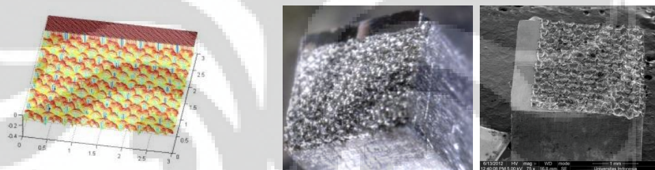
Gambar 5.27 Perbandingan mapping citra input dengan hasil pemesinan pada pola garter stich (127x150 pixel, steel)
