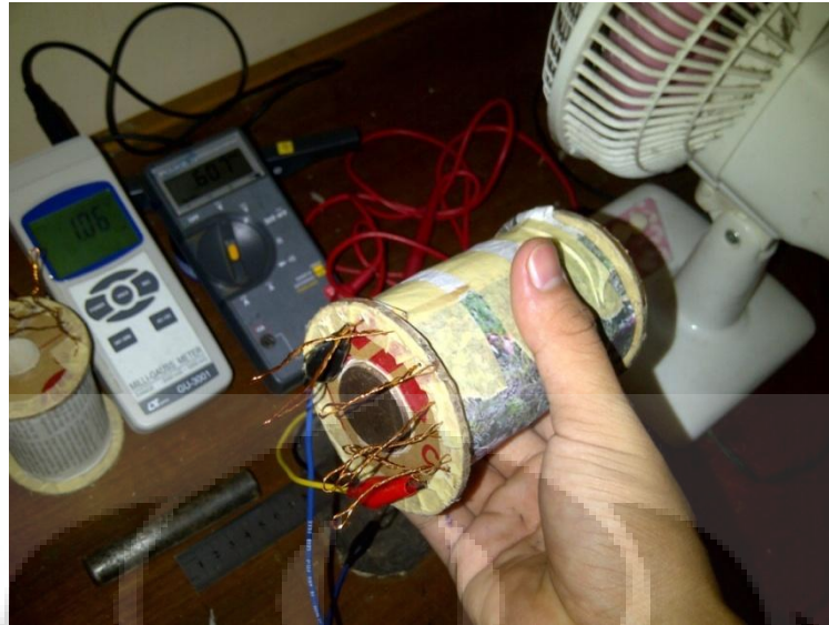
Gambar 4.5 Pengujian solenoida (dengan inti) dengan sumber kipas angin
