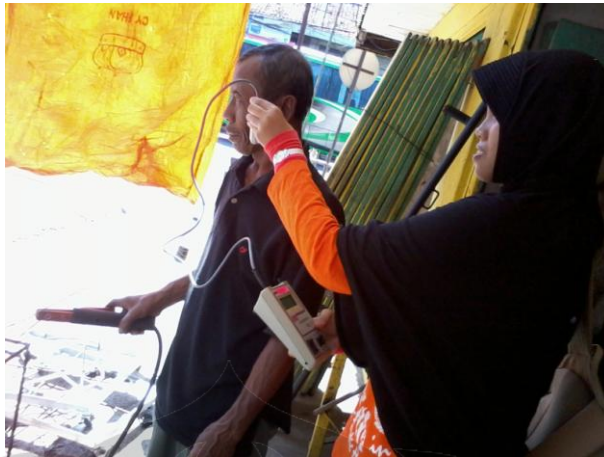
Gambar 5. Pengukuran Intensitas Radiasi Sinar UV menggunakan Radiometer UV-B
