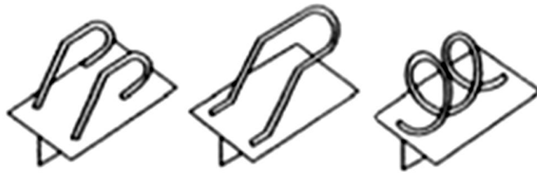
Gambar 2.12 Penghubung geser anchor , hoop , dan spiral
