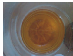
Gambar 4. 5. Larutan 3,5% NaCl tanpa inhibitor setelah perendaman
