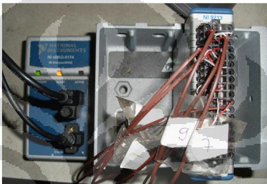
Gambar 3.7 Instrumen data akuisisi
