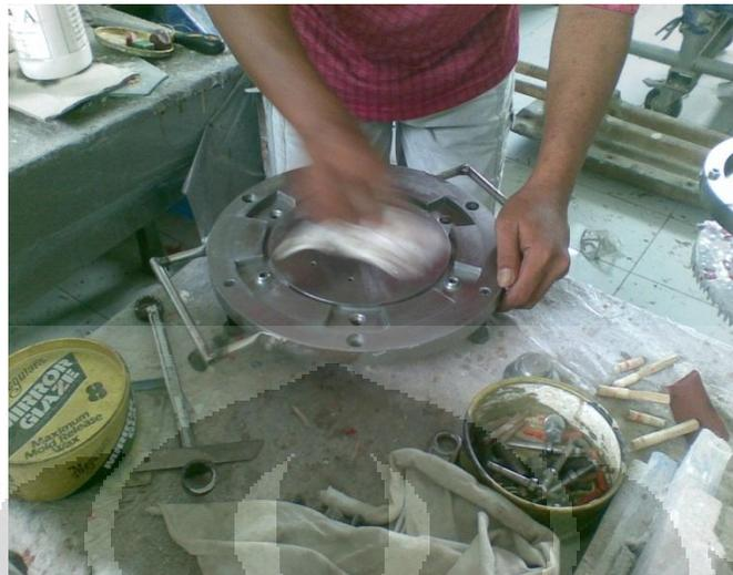
Gambar 3.12 Pembersihan cetakan rotor
