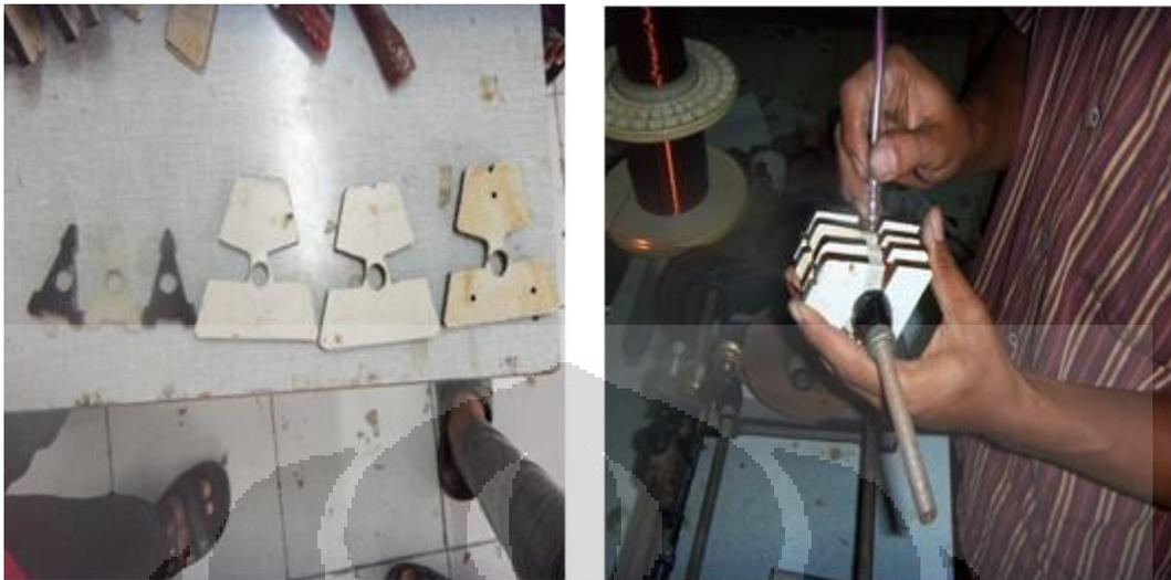
Gambar 3.5 Mempersiapkan Mal Untuk Proses Melilit Kumputan Stator
