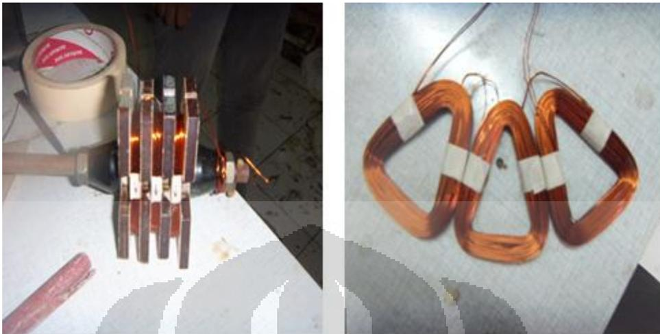
Gambar 3.7 Proses Pembuatan Kumbaran Stator
