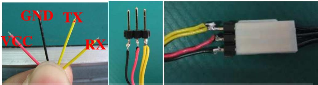
Gambar 3.6. Kabel Servo Kondo pada Roboard
