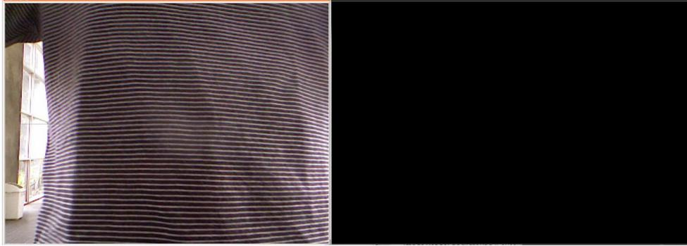
Gambar 6.9 Deadzone pada Kinect, terjadi pada jarak kurang dari 40 cm.
