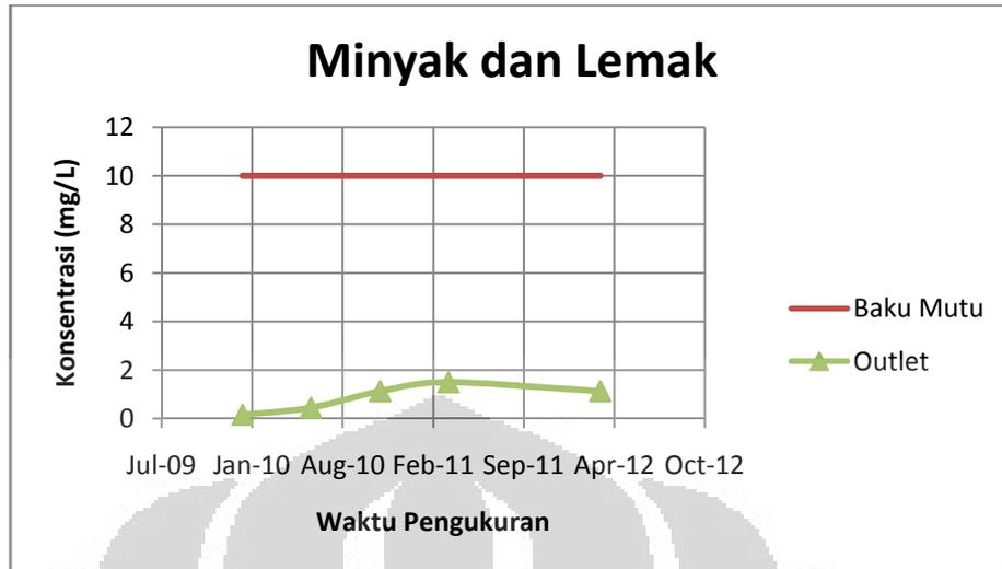
Gambar 5.4 Grafik kandungan minyak dan lemak pada effluent IPAL
