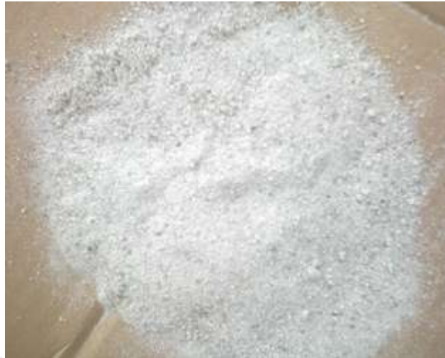
Gambar 3.5 Pasir silika mesh 20-40 yang digunakan pada FBC UI
