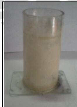
Gambar 4.1. Tabung gelas berpenghantar ( Inner Wall Conductive Glass Tube atau IWC GT) yang telah dilapisi TiO 2 menggunakan metode dip coating
