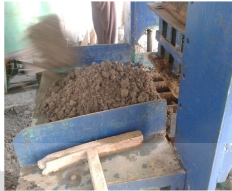
Gambar 14. Campuran Paving Block Siap Dicetak
