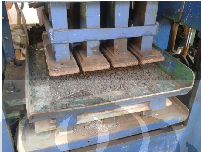
Gambar 4.11 Campuran paving block yang siap dicetak
