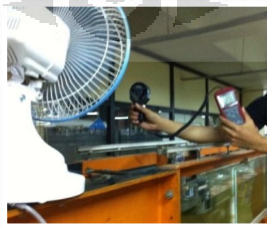
Gambar 4.7.9 simulasi beban angin dan pengukurannya
