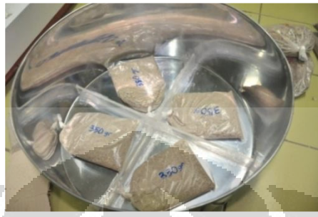
Gambar 4.7.5 Beban displacement dengan pasir
