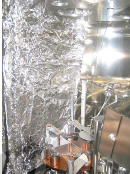
Gambar 3.3. Kawat pemanas tempat material sumber diletakkan
