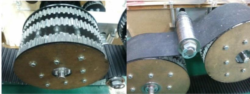
Gambar 3.3 Roda dan Pengencang Belt
