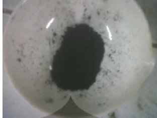
Gambar 3.17 Karbon aktif setelah kalsinasi dalam furnace 400°C selama 4 jam
