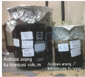
Gambar 3.7 Perendaman arang dengan zat activator
