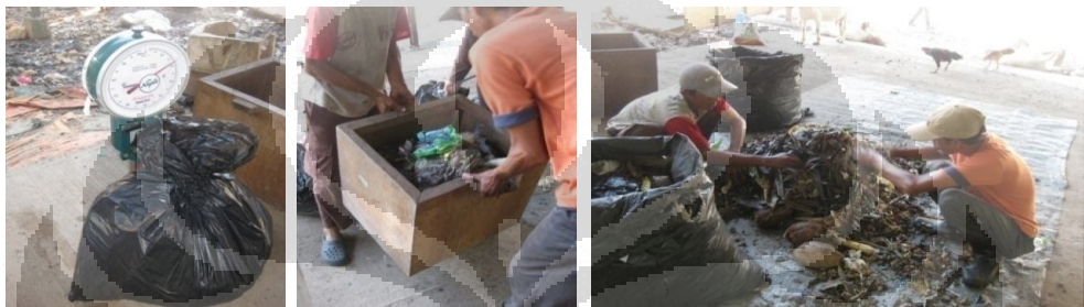
Gambar 5.2. Proses Pengukuran Komposisi (Kiri-Kanan: Penimbangan Sampah – Sampah Dihentakkan – Pemilahan Sampah)
