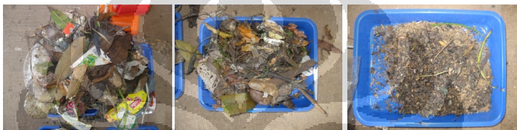
Gambar 5.5. Hasil Pengukuran Partikel Sampah (Kiri-Kanan: >40 mm, 40\text{mm} > x > 8\text{mm} , < 8\text{mm} )
