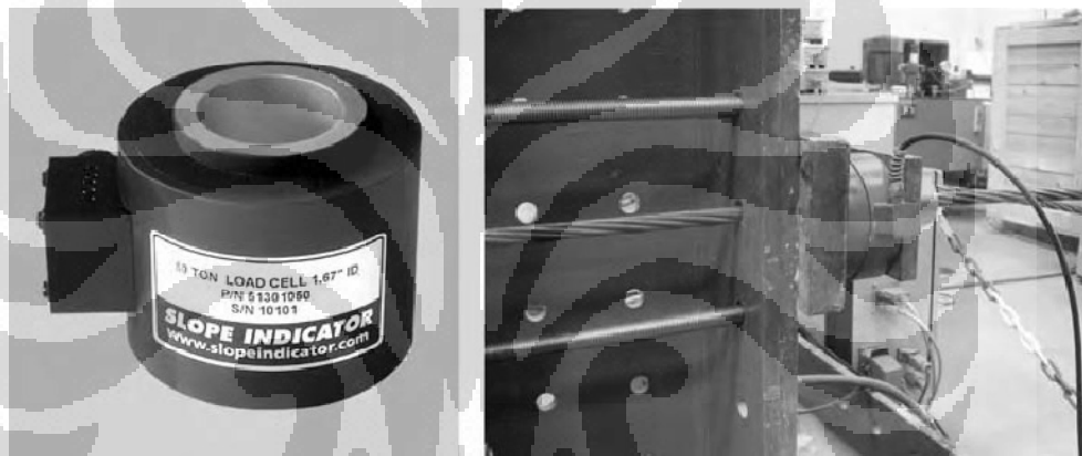
Gambar 2.7 Contoh centre-hole load cells dan pemasangannya
