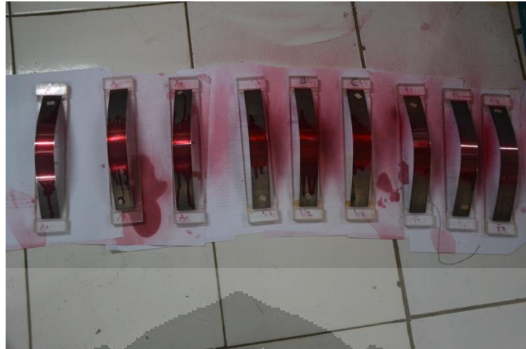
Gambar 4. 15 Sampel diberi penetrant
