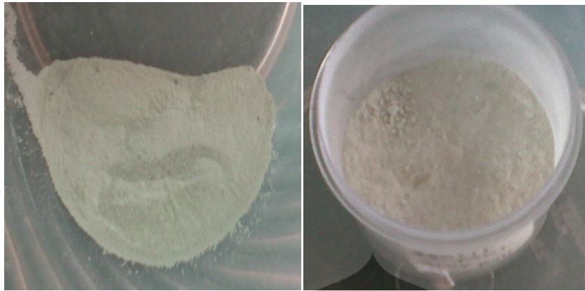
Gambar 4.4 Zeolit sebelum aktivasi (kiri) dan setelah diaktivasi (kanan)
