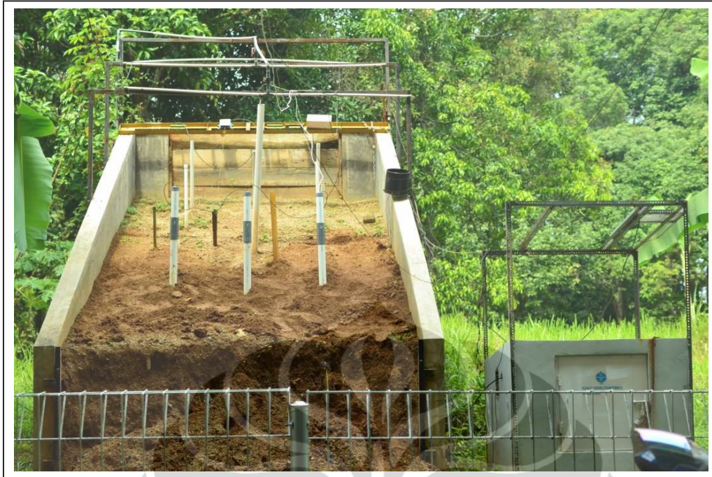
Gambar 4.19 Ujicoba Jaringan Inklinometer pada bukit buatan
