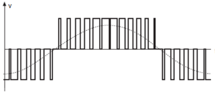
Gambar 2.13. Gelombang keluaran inverter berbentuk sinusoidal murni [8]
