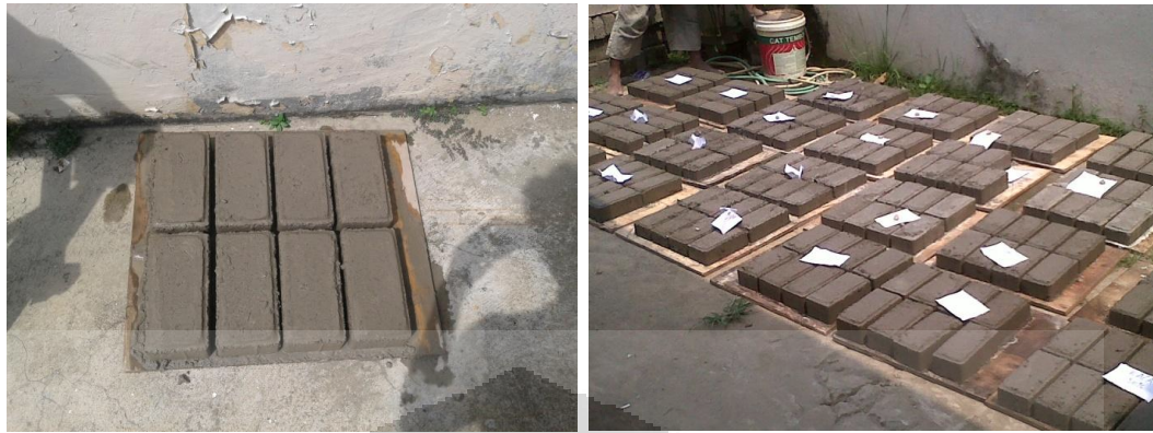
Gambar 9. (a) Jumlah Paving Block Sekali Cetak, 8 Buah (b) Paving Block yang Baru Dicetak
