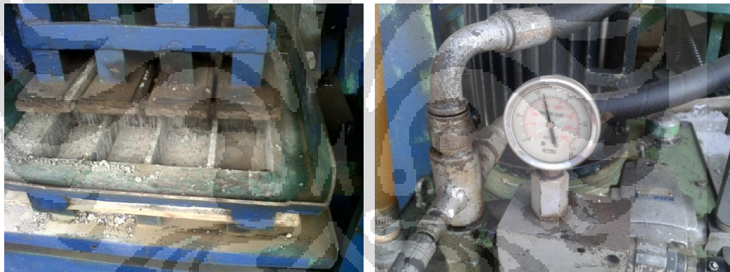
Gambar 6. (a) Cetakan dan Alat Pemasakan Paving Block (b) Dial Gauge Tekanan Alat Pemasakan Paving Block
