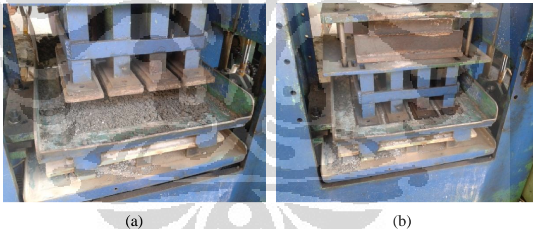
Gambar 8. (a) Campuran Paving Block Siap Dipadatkan (b) Proses Pencetakan dan Pemasakan Paving Block
