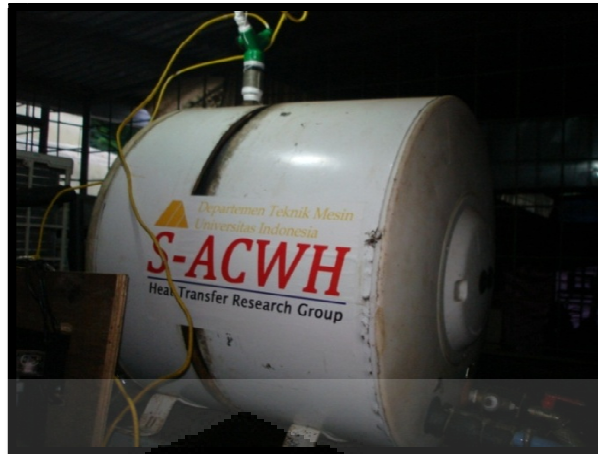
Gambar 3.4 Tangki penyimpanan air
