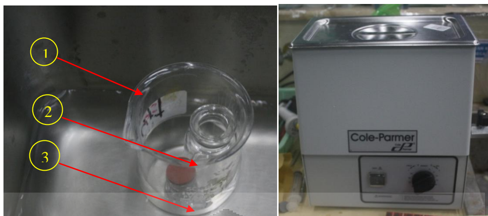
Gambar 3. 6. Pencucian benda kerja menggunakan ultrasonic cleaner
