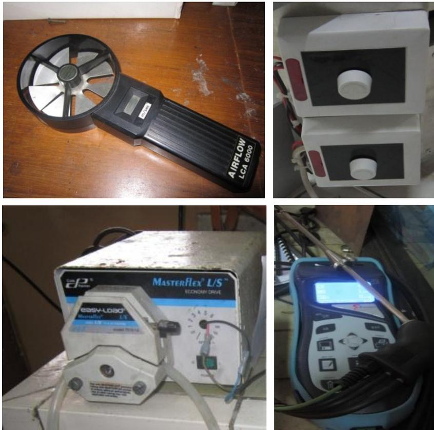
**Gambar 4.8** Peralatan Uji Emisi CO. Anemometer (kiri-atas), pompa vakum (kiri-bawah), *dimmer lamp* (kanan-atas), dan *Gas Analyzer* (kanan-bawah)
