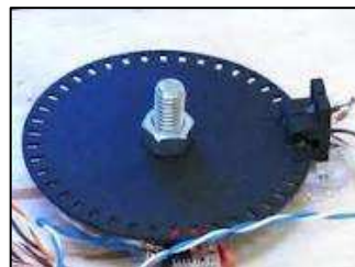
Gambar 2.22 Bentuk fisik rotary encoder [13] .
