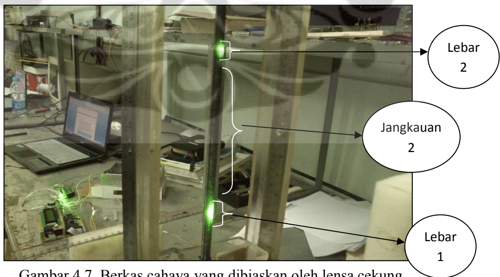
Gambar 4.7 Berkas cahaya yang dibiaskan oleh lensa cekung
