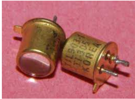
Gambar 2.16 Bentuk fisik fototransistor [15]
