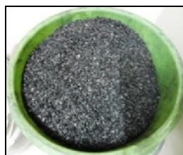
Gambar 4.2 Karbon aktif yang sudah dikeringkan
