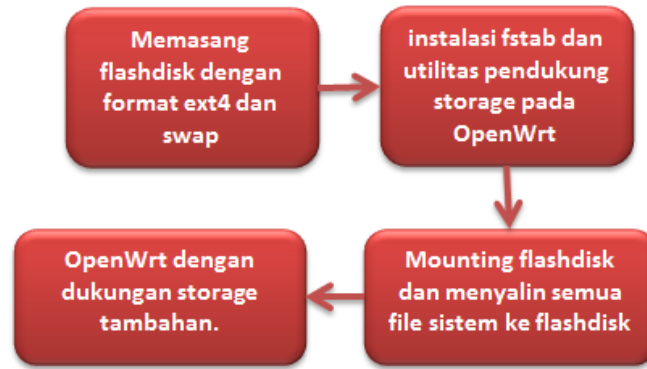
Gambar 3. 16 alur instalasi ExtRoot
