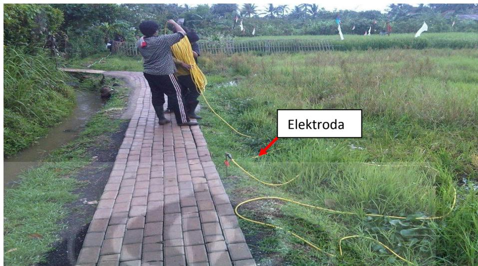
Gambar 3. 6 Proses pembentangan kabel dan penyatuan elektroda dengan sensor sebelum dilakukan pengukuran
